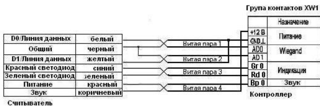
Рис. 7. Подключение считывателей с использованием витой пары
